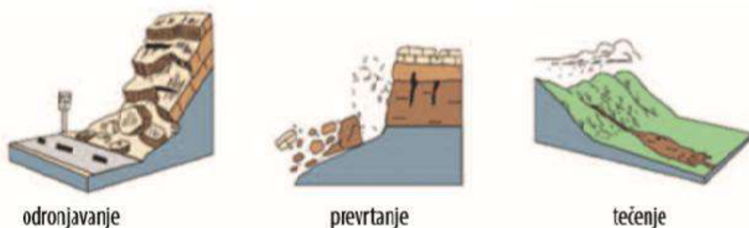
Slika 14: Prikaz osnovnih tipova klizanja prema mehanizmu kretanja
